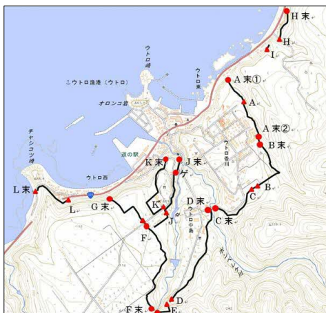
図 1. ウトロ市街地を防衛する電気柵の配置図 (地理院タイル使用). 海岸が弱点.
